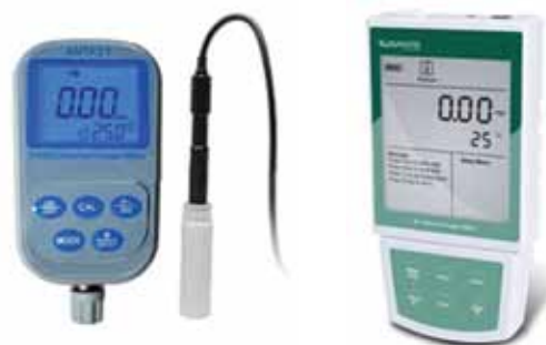
Рис.3: Кислородомеры – предназначены для измерения концентрации растворенного кислорода в воде и водных растворах (мг/л или промилле) и температуры воды в градусах Цельсия (°C) или Фаренгейта (°F).
